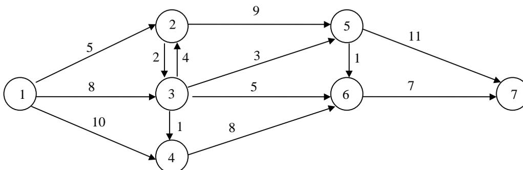
determinare il flusso massimo dal nodo 1 al nodo 7, utilizzando l'algoritmo di Ford-Fulkerson.
