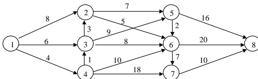
Determinare il cammino di lunghezza minima dal nodo 1 al nodo 8, utilizzando l'algoritmo di Dijkstra.
