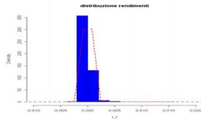
Istogramma dei residui di un modello ARMA(1,1) su una serie generata da un processo ARMA(1,1)
