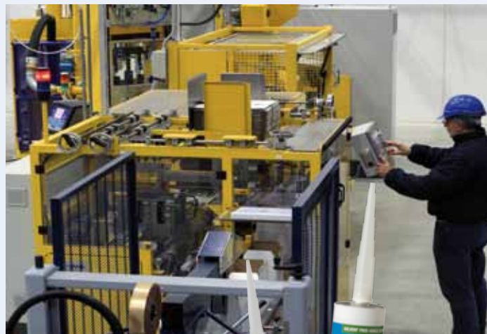
Il nuovo impianto per la produzione ed il confezionamento di sigillanti poliuretanici ad alta viscosità
