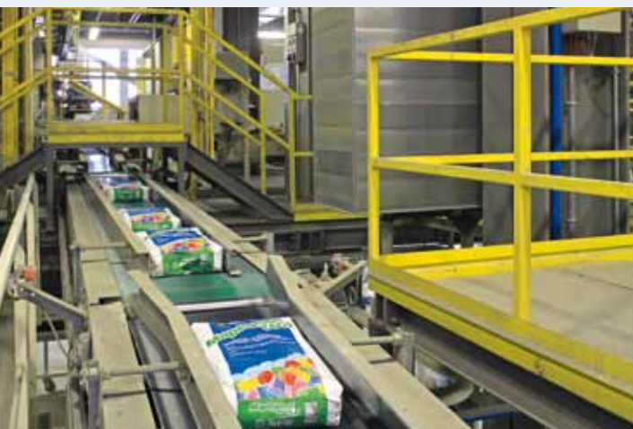
Il nuovo impianto di malte speciali (capacità produttiva 100000 tons/anno)
