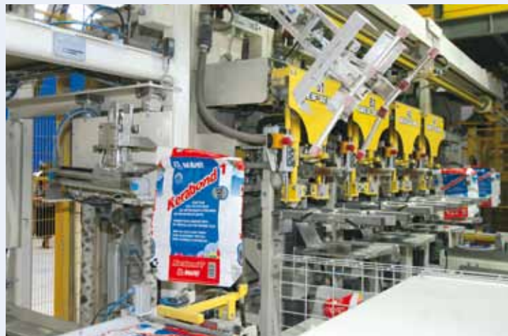
L'impianto dedicato all'imballaggio dell'adesivo Kerabond all'interno dello stabilimento
